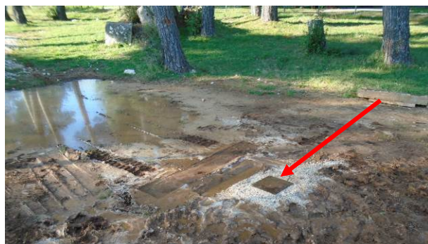
Piezometarska konstrukcija sa zaštitnom čeličnom kapom.
